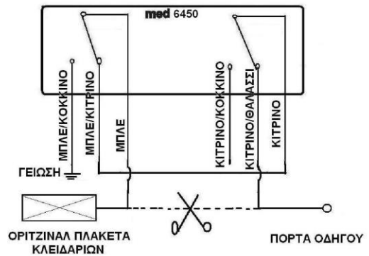
ΣΥΝΔΕΣΜΟΛΟΓΙΑ ΚΛΕΙΔΑΡΙΩΝ ΠΟΥ ΜΕ ΚΟΨΙΜΟ ΚΑΛΩΔΙΟΥ ΤΟ ΑΥΤΟΚΙΝΗΤΟ ΚΛΕΙΔΩΝΕΙ
